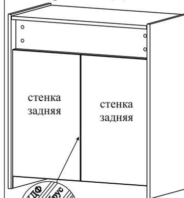
Стенки задние вставляются в пазы, соединив брусом соединительным (П). К стенке горизонтальной и дну стенки задние крепятся саморезами 3,0\*20 (М) через шайбы металлические (К) с шагом, примерно, 130 мм.
