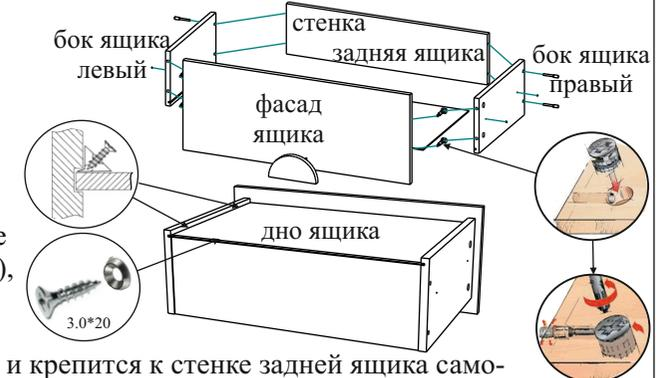
Бока ящика крепятся к стенке задней ящика евровинтами (А), к фасаду ящика - стяжками эксцентриковыми (Г).
