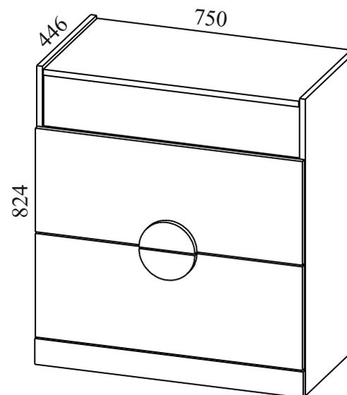
Габаритные размеры: ширина - 750 мм, высота - 824 мм, глубина - 446 мм.
