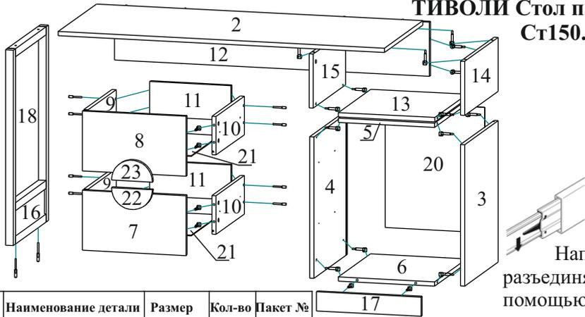
Направляющие разъединяются с помощью нажатия пластикового рычажка при вытягивании внутреннего полоза.
